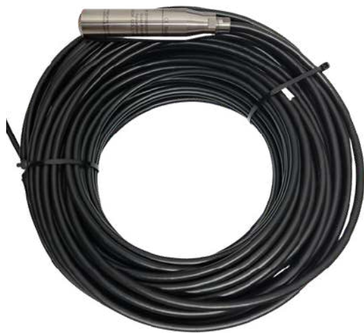
Sensor de nivel Freático
